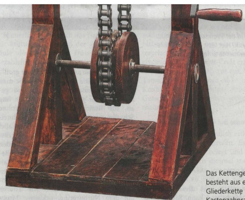
Das Kettengetriebe besteht aus einer Gliederkette über einem Kastenzahnrad.
