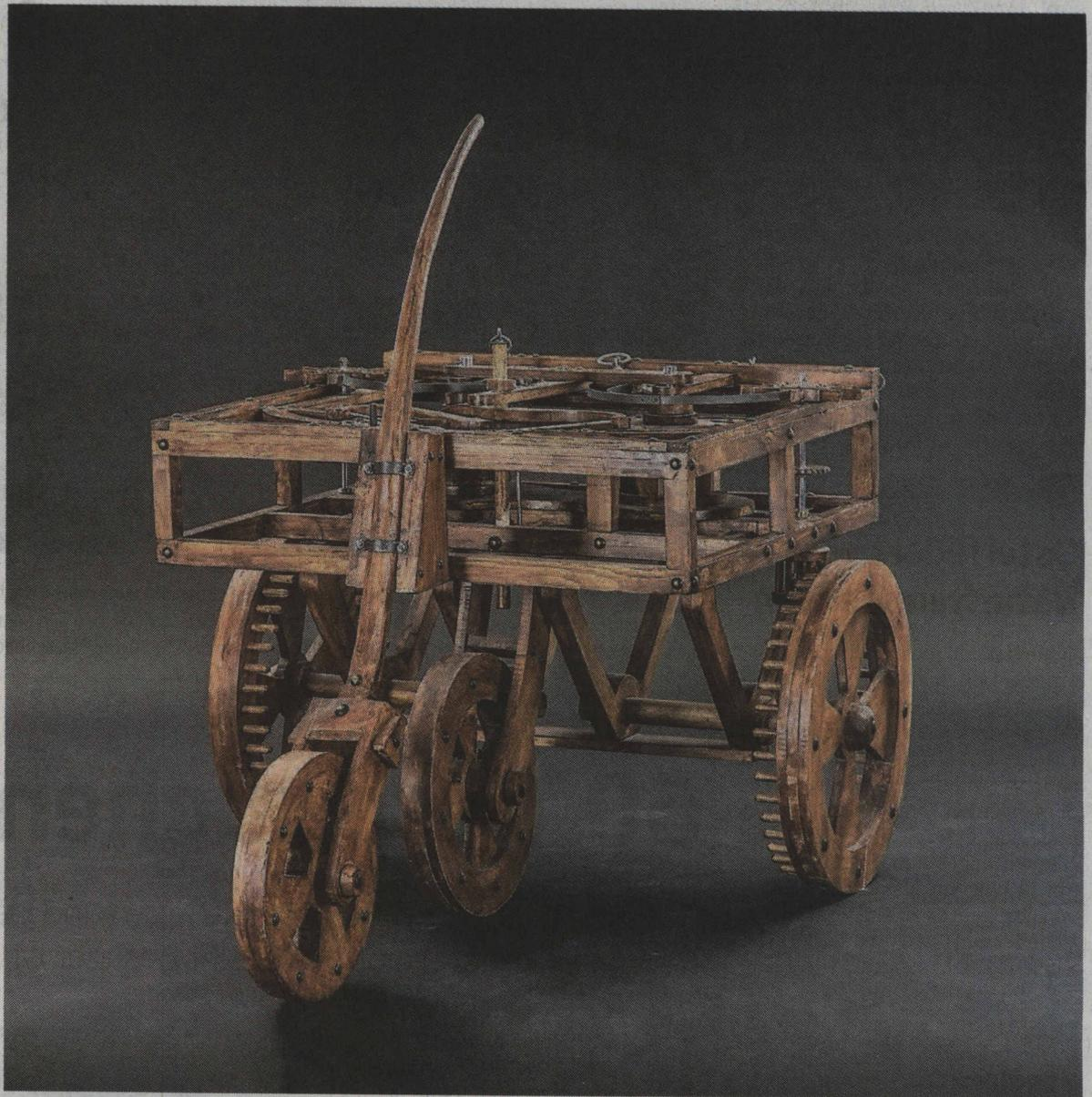
Ausgelöst durch einen Federmechanismus wird kinetische Energie freigesetzt – und das Automobil setzt sich in Bewegung. Lenken lässt sich das knapp zwei Meter lange Gefährt auch. Die Reichweite liegt freilich noch unter der von modernen E-Autos.
