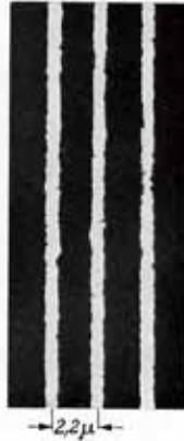
Fig. 1. Drei für Interferenzversuche mit Elektronenwellen hergestellte Feinspalte in einer 2 \mu dicken Cu-Folie
